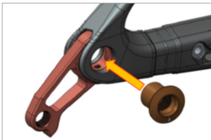
Introduzca lateralmente la tapa-rosca atravesando la puntera y la pata de cambio
