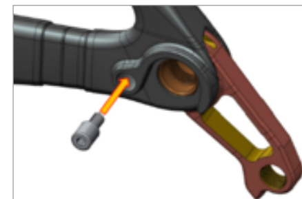
Inserire la seconda vite nella parte posteriore del forcellino ( massimo serraggio 1.5 N/M)
