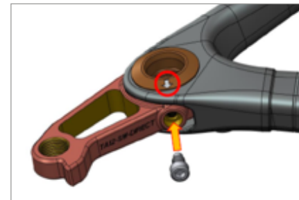
Asegúrese de que la flecha de referencia apunte hacia el agujero de sujeción. Introduzca el tornillo (Torque máximo 1,5Nm)
