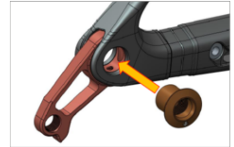
Introduzca lateralmente la tapa-rosca atravesando la puntera y la pata de cambio
