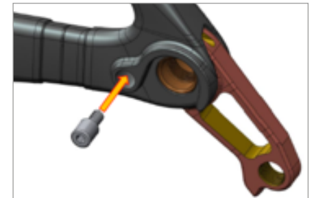
Introduzca el segundo tornillo en la parte interna de la puntera (torque máximo 1,5Nm)
