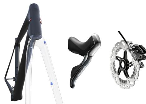
Il telaio e la forcella della Solace disc montano una pinza postmount standard. Sono compatibili con rotor dei freni dal diametro min. 140mm e massimo 160mm.
