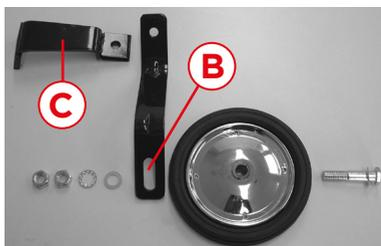
3. Monte ahora el tornillo y las tuercas (con sus arandelas) como se muestra abajo, para sujetar la rueda a la parte B.
