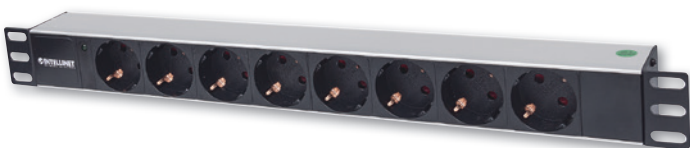
19" 8-fach Steckdosenleiste / PDU, Schutzkontakt, 1 HE [714037] EU CEE 7/3-Steckdosen, LED-Anzeigen, integriertes 1,8 m Stromkabel mit EU CEE 7/4-Stecker
