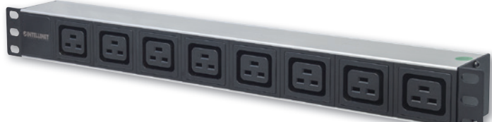
19" 8-fach C19-Kaltgeräte-Steckdosenleiste / PDU, 1 HE [163613] Abnehmbares 2 m Stromkabel mit EU CEE 7/4-Stecker und rückseitigem C20-Stromeingang
