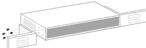
Użyj dostarczonych ze stojakiem śrub, aby przymocować przełącznik Intellinet do stojaka.
