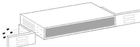
Utilizzare le viti fornite con il rack dell'apparecchiatura per montare lo switch dati Intellinet sul rack.
