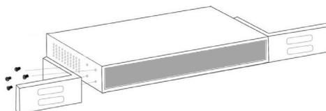
Utilice los tornillos que se proporcionan con el bastidor del equipo para montar el switch (comutador) de datos Intellinet en el bastidor.
