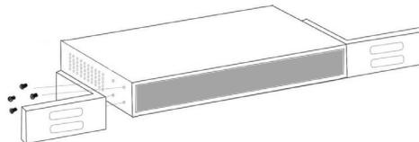
Verwenden Sie die als Zubehör beiliegenden Schrauben, um den Intellinet Data Schalter auf dem Gehäuse anzubringen.
