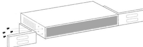
Utilisez les vis fournies avec le rack d'équipement pour monter le commutateur de données Intellinet sur le rack.
