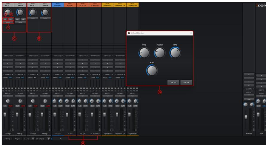
如你所见，界面中有“虚拟通道”（A）（Mac 版本中没有这一功能，因无需使用——详情请参阅 iO Pro 手册）。左上角是可调节的输入控制旋钮。输入 3 和 4（B）为线性输入，因此其选项少于左上角的两个麦克风 / 线性 / 乐器输入（1 和 2）（C）。点击“+48V”按钮（D）可开启幻象电源。“INST”按钮（E）可在线性输入、乐器输入和麦克风输入之间切换。点击“Monitor”按钮（F）会弹出“监听窗口”（G），在该窗口中可选择和调整多项监听设置（如耳机音量）。
