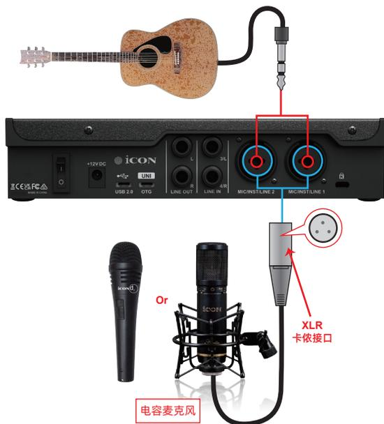
**注意：**使用动圈麦克风的用户，请确保在插入麦克风前将 + 48V 幻象电源开关调至“关闭”状态，否则可能会损坏麦克风。
