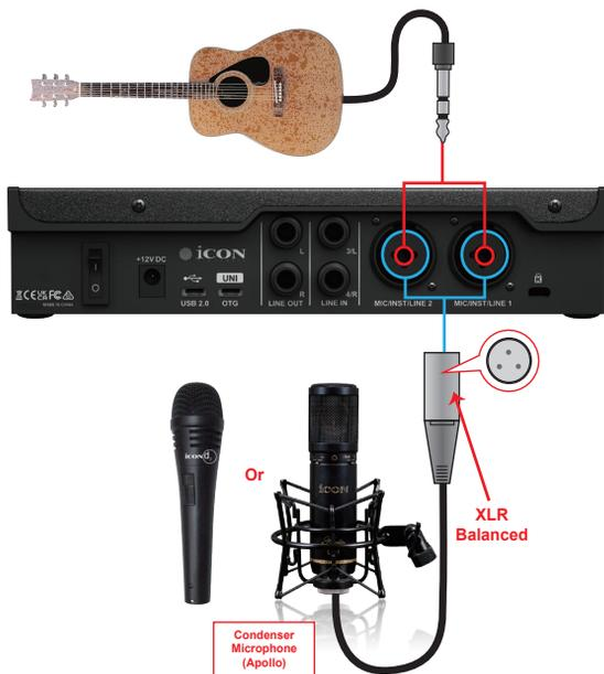
**注意:** ダイナミックマイクを使用する場合、マイクを接続する前に +48V ファントム電源スイッチが「OFF」であることを確認してください。そうしないと、マイクが破損する恐れがあります。
