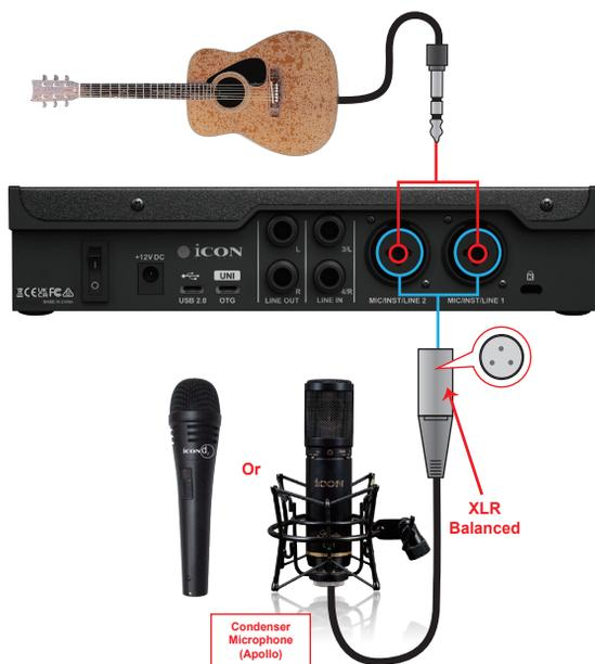
**Nota:** Per gli utenti di microfoni dinamici, assicurarsi che l'interruttore di alimentazione Phantom +48V sia impostato su "OFF" prima di collegare il microfono, altrimenti potrebbe danneggiare il microfono.
