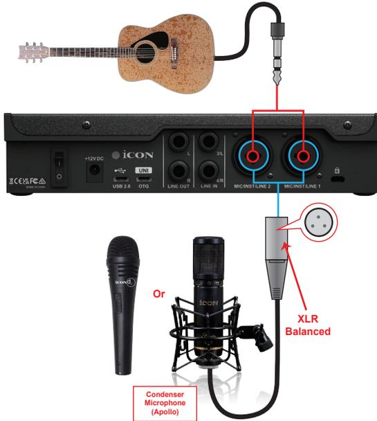
**Hinweis:** Für Benutzer von dynamischen Mikrofonen stellen Sie bitte sicher, dass der +48V Phantomspeiseschalter "OFF" ist, bevor Sie Ihr Mikrofon anschließen, andernfalls könnte Ihr Mikrofon beschädigt werden.
