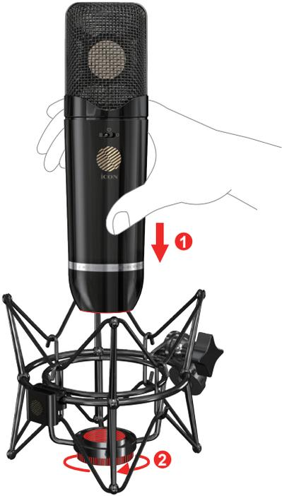
Setzen Sie Ihre magnetische Stoßdämpferhalterung ein, indem Sie sie einfach einrasten lassen:
