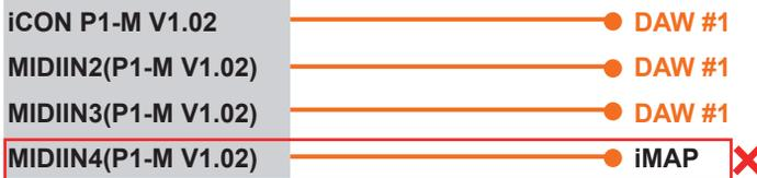
**Nota:** El puerto MIDI 4 es utilizado por el software iCON Pro Audio, iMAP™, para cambiar los tres DAW que utiliza, para actualizar el firmware y para programar la pantalla táctil del panel 16 con las funciones de su elección.
