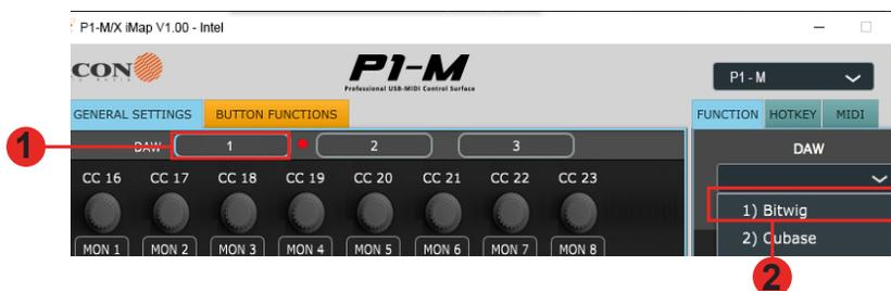
Entonces, has descargado, instalado y abierto el iMAP. Verá los tres botones DAW en la parte superior del iMAP. Estos corresponden a los tres botones DAW en el P1-M.
