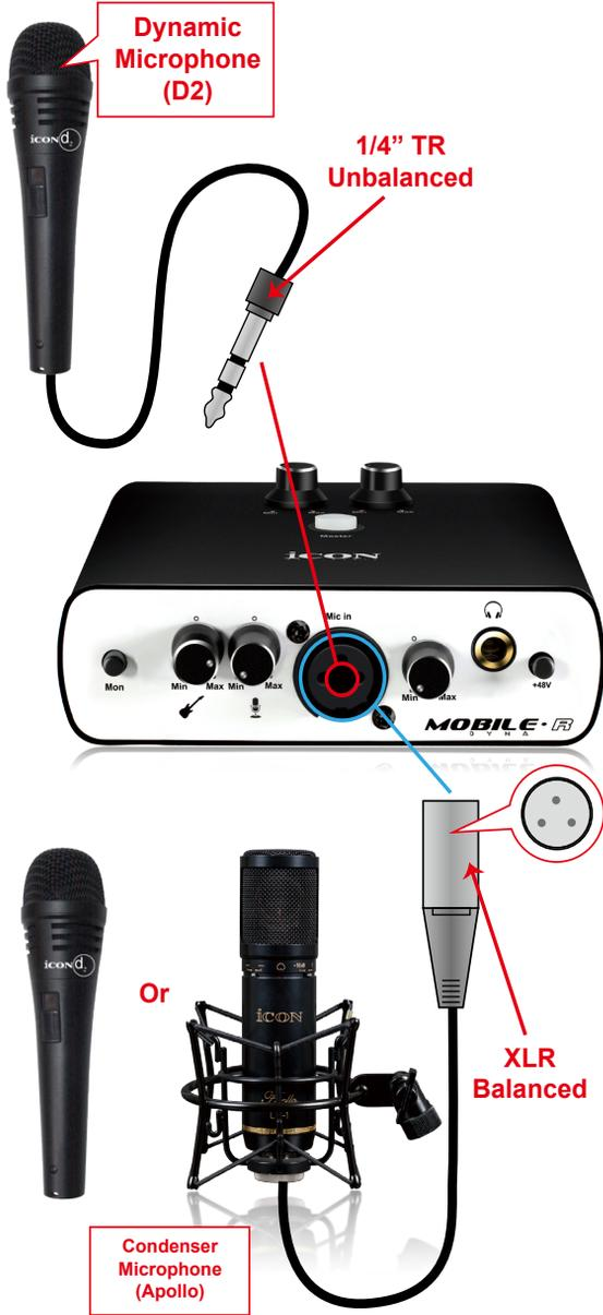
**Attenzione:** Per l'utilizzatore di microfono dinamico, assicurarsi che l'interruttore di alimentazione phantom a +48V sia su "disattivato" prima di collegare il microfono, altrimenti ciò può danneggiare il microfono.
