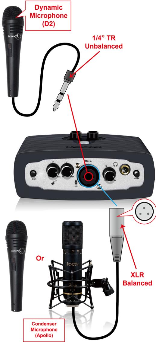
**注意：**对于动圈话筒用户，请在插入话筒之前确保 +48V 幻象电源开关为“关闭”，否则可能会对您的话筒造成损坏。
