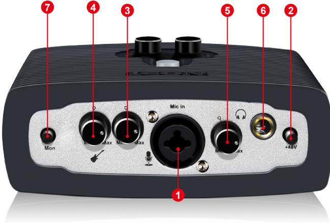
**1. 3 针 XLR (平衡) - 用于带有 +48V 幻象电源或动态麦克风的电容话筒。**
