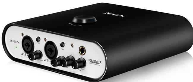
L'interface d'enregistrement USB ICON Pro Audio Duo44 Live fournit un module d'entrée et de sortie audio ainsi qu'une connectivité analogique et numérique avec tout appareil mobile intelligent pour les applications de diffusion en direct. Les principales caractéristiques sont les suivantes :
