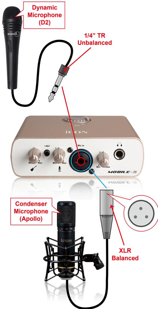
**Hinweis:** Vergewissern Sie sich bitte vor dem Einstecken eines dynamischen Mikrofons, dass der Schalter der +48V Phantomspeisung auf „AUS“ steht, da Ihr Mikrofon ansonsten beschädigt werden könnte.
