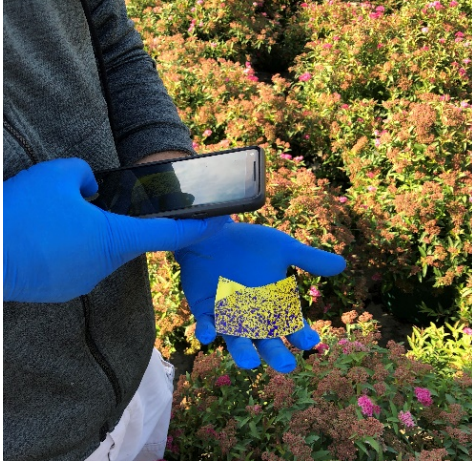
Figura 3. La smartphone app 'SnapCard' usa fotos de las tarjetas hidrosensibles e informa el porcentaje de cobertura de rociado.
