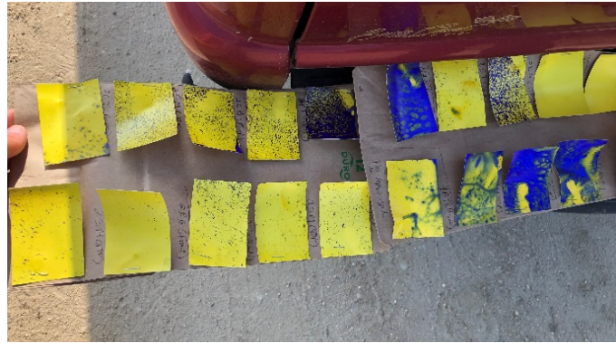
Figura 3. La smartphone app 'SnapCard' usa fotos de las tarjetas hidrosensibles e informa el porcentaje de cobertura de rociado.
