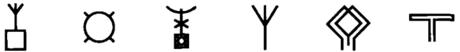
抛物面天线 电话 传真接收器 9 直流电动机 单相变压器 整流元件
