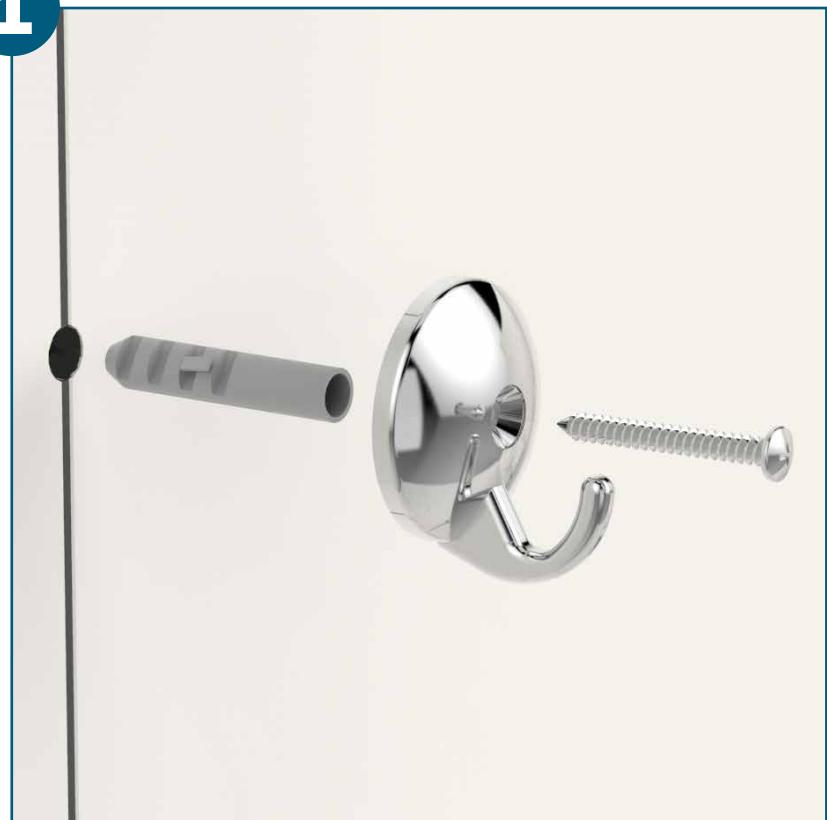
Fure a parede com uma broca para concreto (vídia) de 8 mm e fixe o suporte.
