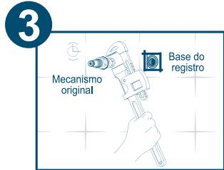
Com uma chave de cano (grifo), retire o mecanismo do registro defeituoso da parede girando-o no sentido contrário ao dos ponteiros do relógio.
