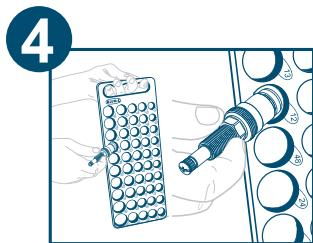
Após a retirada do mecanismo, segure-o pela extremidade que fica fora da parede e introduza a outra extremidade nos furos do Gabarito de roscas Blukit até encontrar o furo que melhor se ajuste a rosca do mecanismo original defeituoso. (Atenção: Certifique-se de que a rosca do mecanismo não fique apertada nem folgada no gabarito). Anote o número do furo do gabarito.
