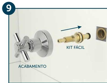
Reinstale o conjunto e reabra o registro geral. Obs.: após a instalação concluída, o acabamento original poderá ser mantido ou, caso seja conveniente, substituído por um modelo que seja compatível ao mecanismo do Kit Fácil de pressão.
