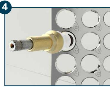
Segure o mecanismo pela extremidade que fica fora da parede e introduza a outra nos furos do gabarito de roscas Blukit até encontrar o furo que melhor se ajuste a rosca do mecanismo original. **ATENÇÃO:** certifique-se de que a rosca do módulo de redução fique perfeitamente ajustada à base do registro. Anote o número do furo do gabarito.
