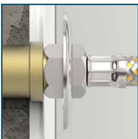
A rosca macho do conector (ligação) flexível deve ser rosqueada **até o final do curso** na rosca fêmea da tomada d'água na parede, de forma que a rosca macho fique completamente inserida.
