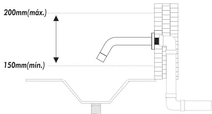
**Coloque a canopla e rosque a bica até fixá-la firmemente. Evite uso de ferramentas.**
