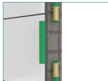
5. Posicione o novo tubo e move as luvas conectando-as ao tubo na parede.
