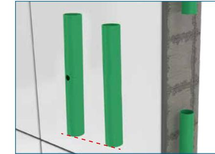
2. Corte um novo tubo com o comprimento do tubo defeituoso que foi retirado.
