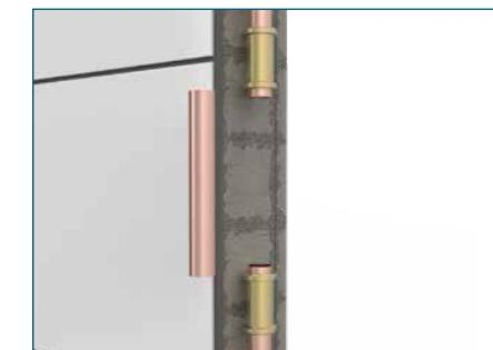
6. Posicione o novo tubo e mova as luvas conectando-as ao tubo na parede.
