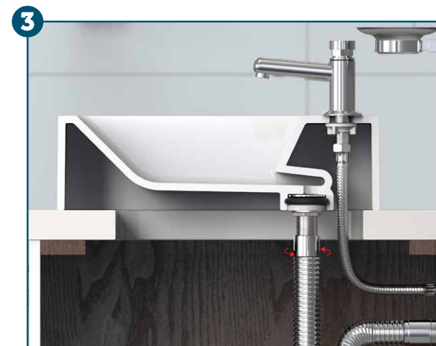
3 Após firmá-la, rosqueie o sifão na válvula de escoamento. Luego de afirmarla, enrosque el sifón en la válvula de escurrimiento.
