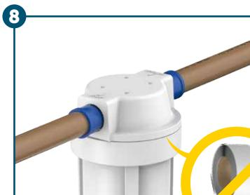
**Em caso de vazamento, verifique as conexões e o aperto do copo do filtro. NÃO UTILIZE fita veda rosca na tampa do filtro.**
