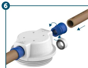
**Encaixe o segundo adaptador compatível com o filtro e o cano. Cole a extremidade suspensa no cano adaptador.**
