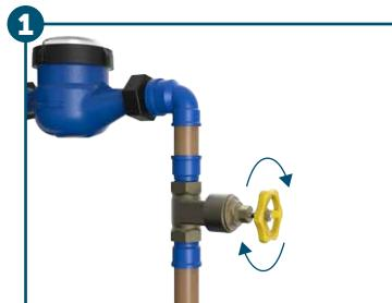
**Feche o registro geral de água.** Você pode instalar o filtro para PONTO DE ENTRADA antes da caixa d'água ou junto ao cavaletes (após o hidrômetro).
