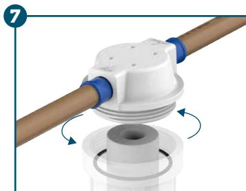
**Observe se o anel o'ring utilizado para a vedação do filtro está devidamente alojado no copo e ajuste o refil interno, encaixando-o como indicado na figura.**
