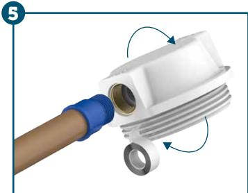
**Encaixe e gire a tampa no adaptador usando fita veda rosca Blukit de 12 mm.**
