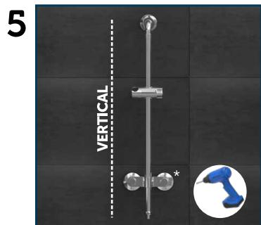
Na outra extremidade da barra deslizante, passe o sistema de sucção\* e regule a barra de forma que a extremidade inferior da barra fique alinhada verticalmente com a superior.
