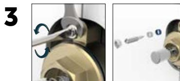
Solte a porca (26) com a ajuda de uma chave de fenda, desrosqueie o parafuso injetor (349423) e troque as vedações ou o injetor completo. **NOTA:** Realize a limpeza do interior do canal, desobstruindo a passagem de resíduos.
