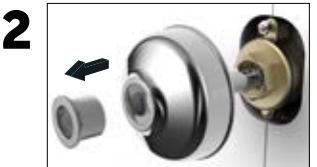
Dê a descarga para saída do restante d'água e retire o preme (1) para remover a canopla (2).
