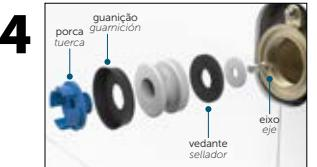
Com o pistão (349435) retirado, solte a porca (18) e substitua a guarnição (19 ou 20), em seguida, desrosque o eixo (24) e substitua o vedante (22).
