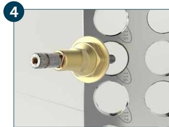
Segure o mecanismo pela extremidade que fica fora da parede e introduza a outra nos furos do gabarito de roscas Blukit até encontrar o furo que melhor se ajuste a rosca do mecanismo original. **ATENÇÃO:** certifique-se de que a rosca do módulo de redução fique perfeitamente ajustada à base do registro. Anote o número do furo do gabarito.
