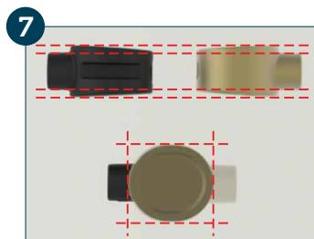
Identifique a cunha emborrachada que mais se aproxima da cunha do mecanismo original. Compare a altura, largura e espessura de ambos os mecanismos.
