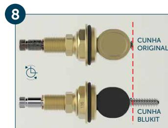
Gire as hastes dos mecanismos até o final (posição do registro completamente aberto) e alinhe as cunhas de modo que fique do mesmo tamanho que o mecanismo original. Se necessário corte parte da haste do MVS.
