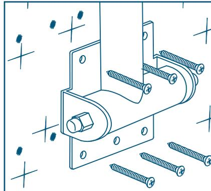
**2.** Posicione a furação da barra de apoio rente aos furos da parede e fixe-a com os parafusos.
