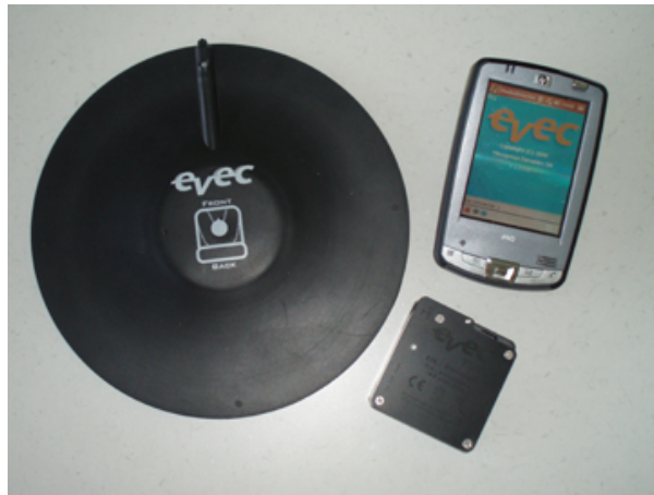
Figure 5 : Système EVEC pour vibrations globales du corps
