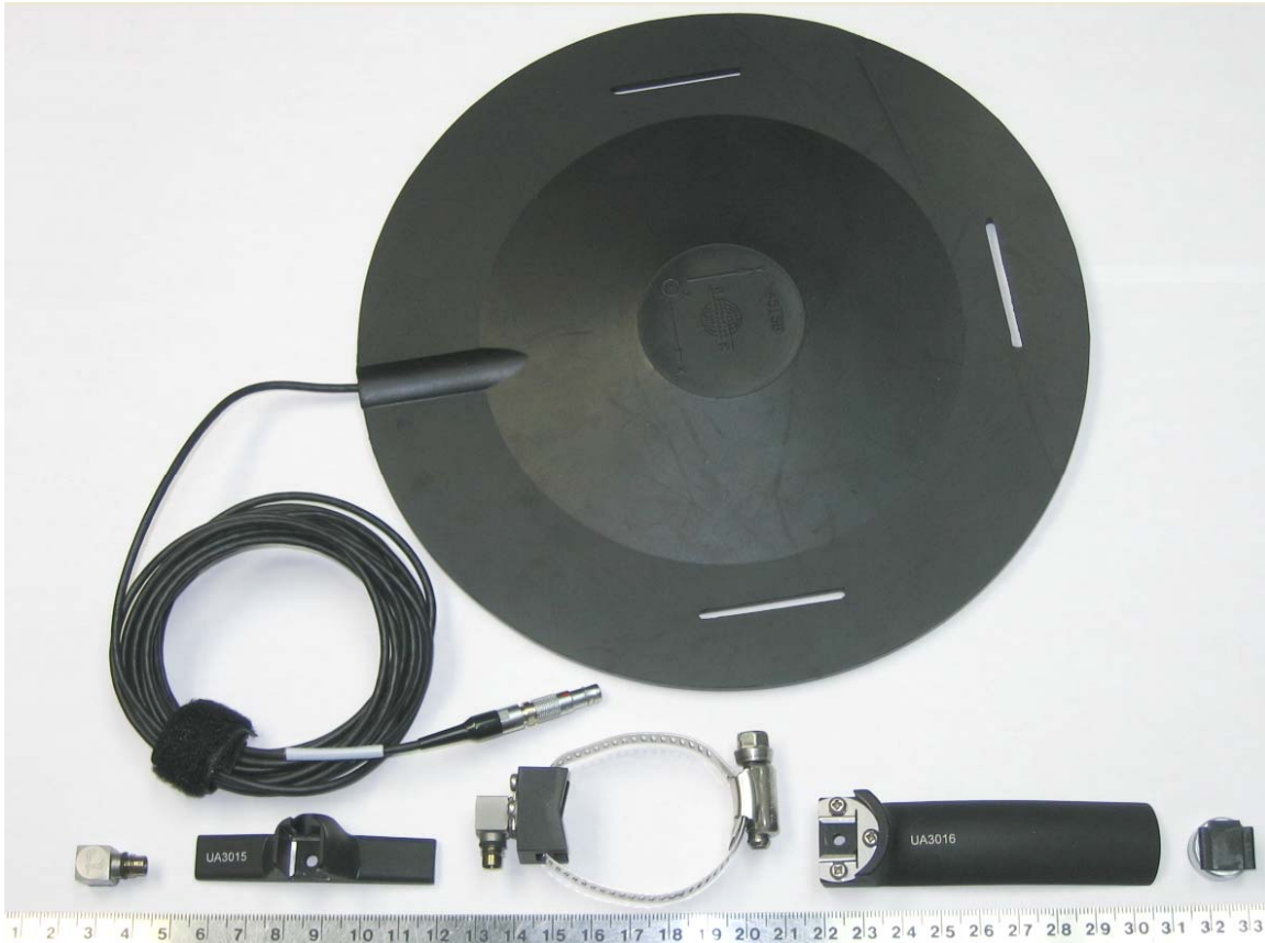
Figure 4 : Exemple d'accéléromètre triaxial et d'accessoires de montage
