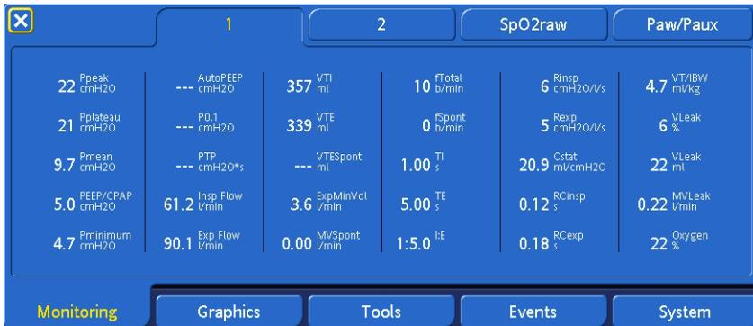
Figure 7-2. Monitored parameter window 1
