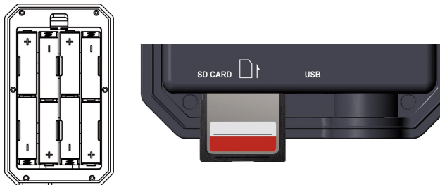
Abb. 5: Einlegen der Batterien und der SD-Karte
