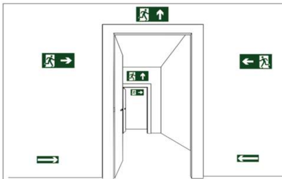
Figura 25: Exemplo de instalação de sinalização (anexo “C”)
