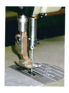
ULTRA HIGH SPEED SINGLE NEEDLE DROP FEED LOCKSTITCH MACHINE
