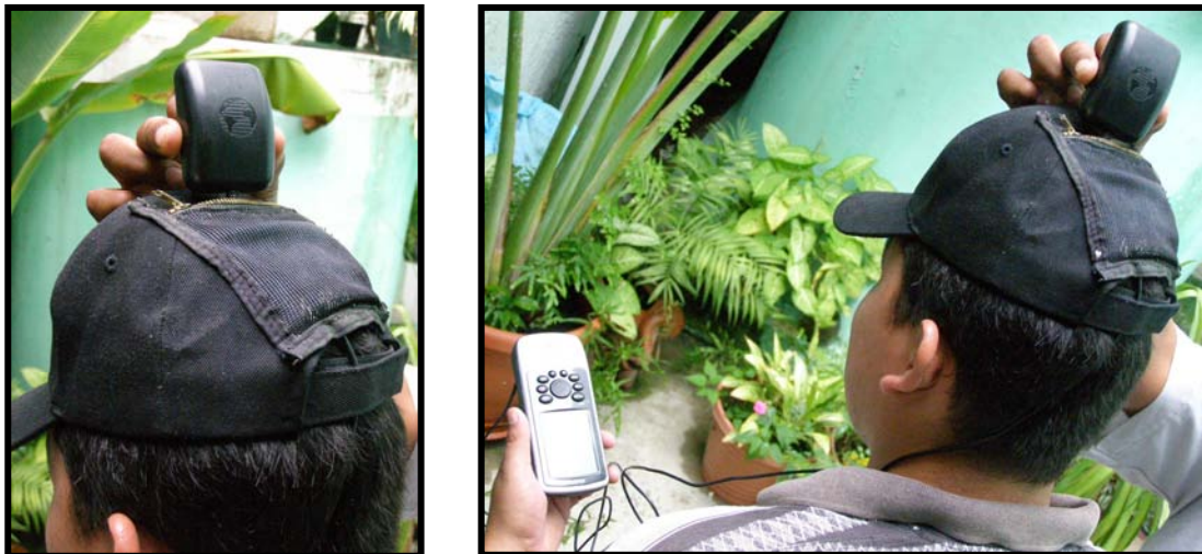
Figura 1. Gorra-GPS utilizada para registrar el movimiento de los xateros en el bosque.
