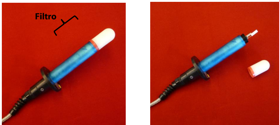
Figura 2-5: Mostrando el THS con filtro y sin filtro
