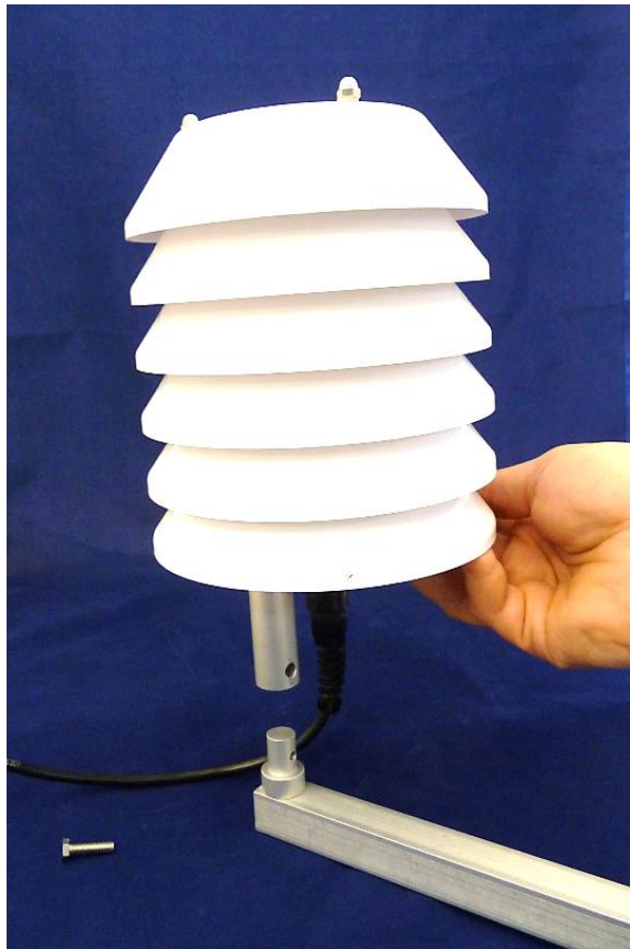
Figura2-1: fijar el conjunto al brazo de soporte
