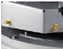
Sistema de nebulización fina de supresión de polvo
