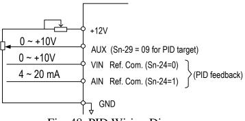
Fig. 48. PID Wiring Diagram
