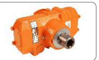
Bomba JP-402 de 2 pistões com camisas de cerâmica resistentes à corrosão e abrasão. Vazão de 38 L/min a 540 rpm. Possui câmara de compensação que garante a vazão constante dos bicos.
