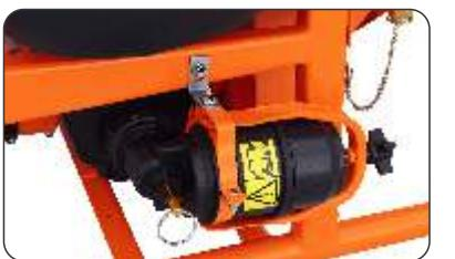
O filtro de sucção tem a função de reter todo e qualquer tipo de impureza antes que a mesma atinja a bomba de defensivo.
