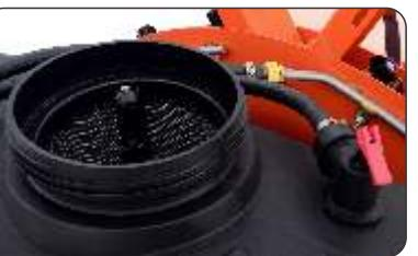
Lava os frascos com calda sob pressão. Incorpora os resíduos de defensivos e voltam automaticamente à calda do tanque.
