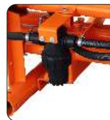
O equipamento é dotado de dois filtros de linha para melhor proteção dos bicos de pulverização contra entupimentos ou desgaste precoce.
