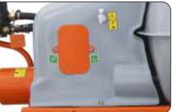
Possui um reservatório de água limpa com capacidade de 15 litros para a lavagem das mãos do operador.
