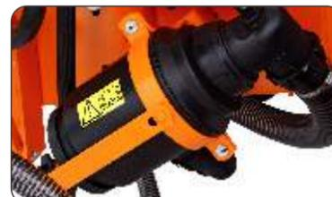
O sistema de filtragem do circuito hidráulico de pulverização é composto por um filtro de sucção, FVS 200, com dois elementos filtrantes de malha de aço inox e fecho rápido; filtros de linha, um para um para cada segmento das barras de pulverização; filtros em todos os bicos, que podem ser escolhidos de acordo com a vazão do bico utilizado.
