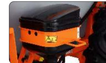
Incorpora o defensivo à água do tanque principal, produzindo a calda de forma prática e segura, sem riscos ao meio ambiente e ao operador. Também utilizado para limpeza das embalagens.
