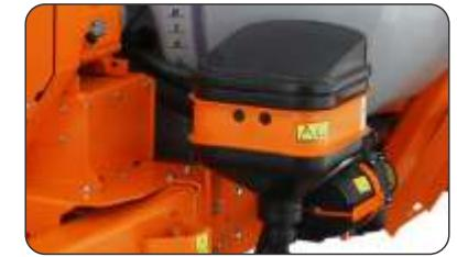
Incorpora o defensivo à água do tanque, produzindo a calda de forma prática e segura, reduzindo os riscos ao meio ambiente e ao operador.
