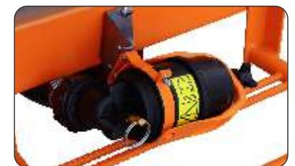
Retém as impurezas contidas na calda, protegendo os componentes do circuito de pulverização.
