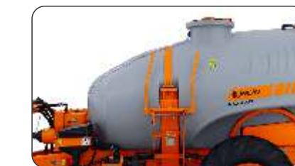
De 4000 litros, polietileno altamente resistente a corrosão. Visor de nível com escala graduada e agitação hidráulica da calda.
