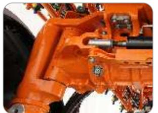
**Bitola ajustável hidraulicamente** de 2,60 até 3,15 m. Proporciona excelente adaptabilidade de transporte em pranchas e aos diversos espaçamentos de culturas.
