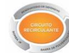
Com o **circuito recirculante**, o agroquímico é bombeado do reservatório para as barras de pulverização e retorna ao reservatório principal, formando um circuito fechado.
