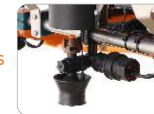
Possui porta **bicos bijet** que permite o ajuste dos parâmetros de aplicação através de dois diferentes **bicos de jato cônico** que podem ser configurados conforme as diferentes necessidades do produtor, como tipo de agroquímico, volume de aplicação, velocidade e condições climáticas. **O formato do porta bico bijet é alinhado e otimiza o fluxo de ar ao seu redor**, conduzindo com **mais eficiência** as gotas de **pulverização até o alvo.**
