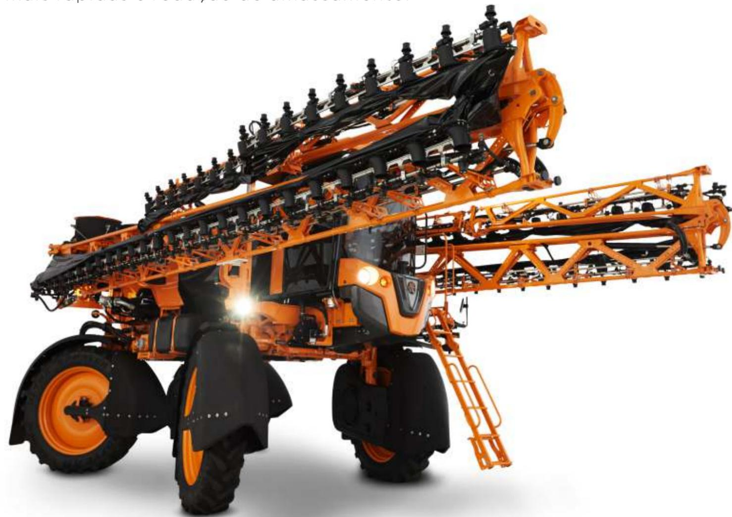
O Uniport 3030 EletroVortex pode ser equipado com o novo sistema direcional **UNITRACK**<sup>®</sup>, que permite **MANOBRAS MAIS RÁPIDAS E PRECISAS COM MENOR RAIO DE GIRO**, proporcionando maior rendimento operacional. Com uma solução inovadora o sistema **REDUZ O AMASSAMENTO NA MANOBRA EM ATÉ 40%**.
