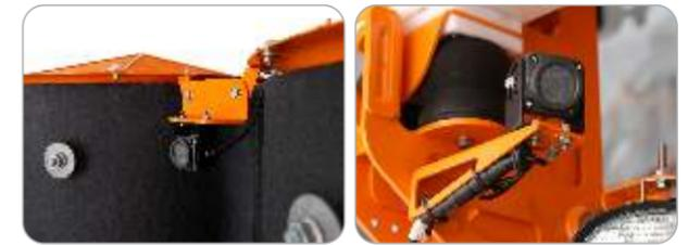
As câmeras localizadas nos **apoios das barras e na parte traseira** permitem **melhor visualização** do espaço ao redor da máquina quando as barras estão fechadas. Essas câmeras possuem um **grande ângulo de regulagem** para se adequar a necessidade de cada operador.
