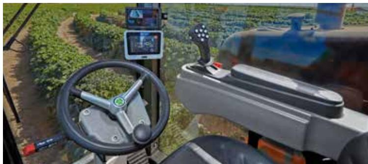
Funciones operativas integradas y controladas automáticamente, que pueden ser predefinidas en el monitor de la cabina. **Y más: monitor Omni 700** con sistema de diagnóstico operativo integrado que informa sobre el funcionamiento general de la máquina.
